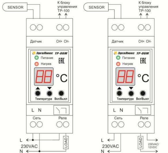
Схема 1. Подключение терморегулятора и нагрузки к общей сети питания
